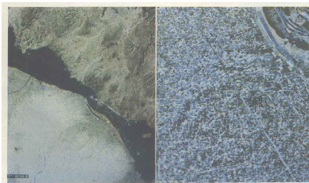
图7 4、5、7 波段合成灰度扩展提取陆地各方向的线性构造和环形构造
